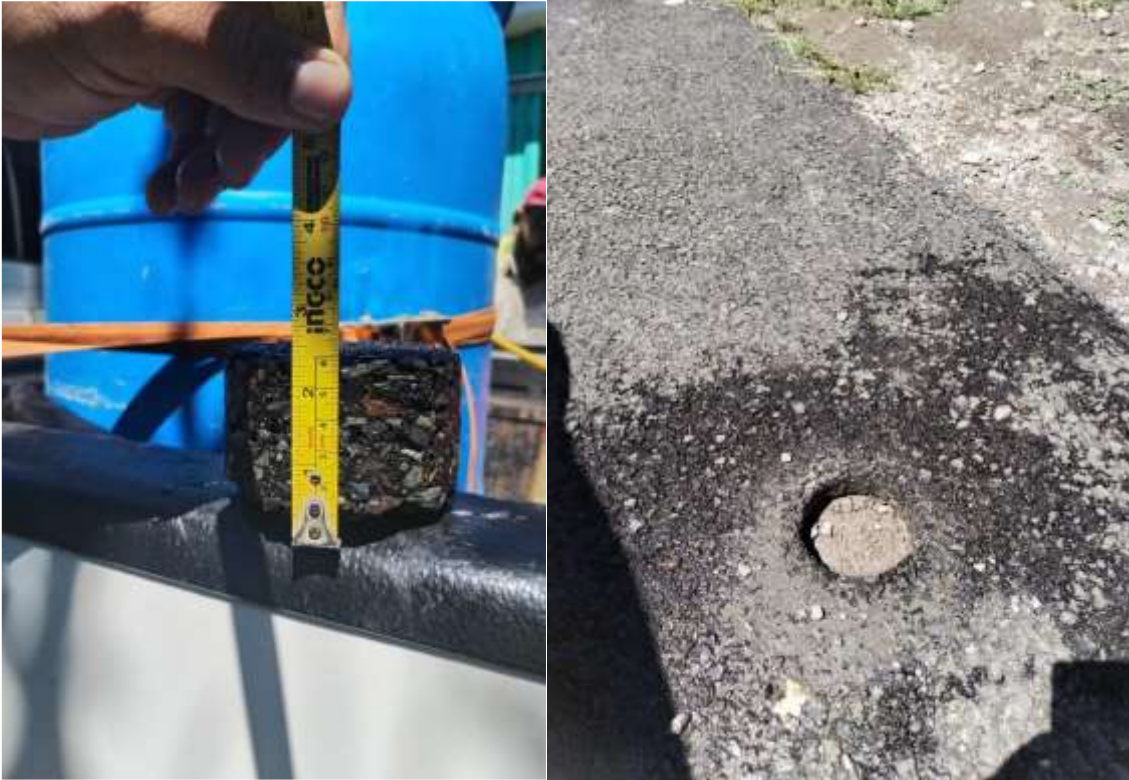
Primera extracción: 6.5 cm de espesor. Fecha: 23/02/2024. Realizado por Consultoría IGSA.
