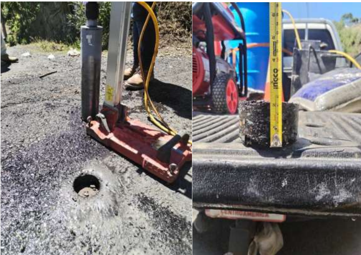
Segunda extracción: 5 cm de espesor. Fecha: 23/02/2024. Realizado por Consultoría IGSA.
